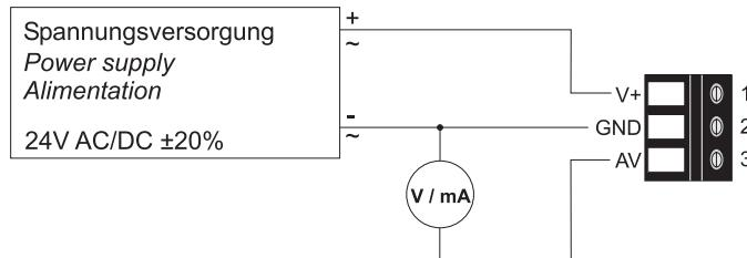
V+ = Versorgungsspannung / supply voltage / alimentation
