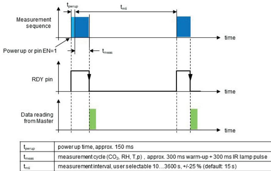
Fig. 7 Timing details (see chapter 4.4.3: „CO<sub>2</sub> Parameter Settings“)
