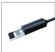
SHS-325 - Spezialfühler zur Messung einsetzender Betauung. Kondensationssensor liefert Signal 1 wenn Benetzung mit Wasser in Folge von Kondensation Einsatz 0...50°C
