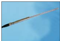
RFTXS-325 - Miniaturfühler zur Messung der Wandfeuchte (Unterputz, Estrich, Fliesen) Sensorabmessungen (D=4,6mm, L=200mm), max. +80°C
