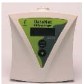
DNL920: interne vocht- en temp. sensor, 4 kanalen voor mA, V, mV, TC, Pt100, Frequentie en Puls
